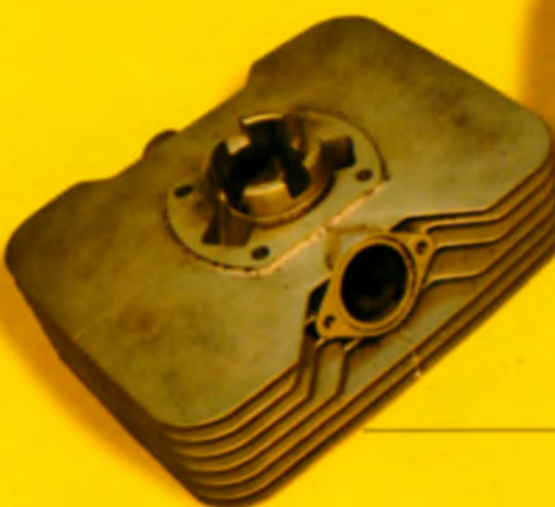
Rechts im Bild der Zylinderdeckel mit Quetschkante und ovalem Brennraum. Dank guter Kühlung reicht Zündkerzen-Wärmewert 260
