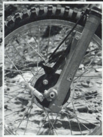
Vorderradbremse mit guter Wirkung
